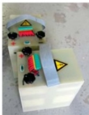
Una coppia di batterie LiPo da 4,3 kWh (ognuna pesa 15,5 kg) fornisce la necessaria energia al motore elettrico da 22 kW
