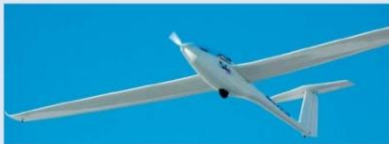
Il Silent 2 Electro decolla in circa 150 metri di corsa a terra e sale a 2 m/s
