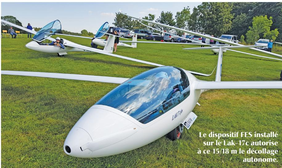
Le dispositif FES installé sur le Lak-17c autorise à ce 15/18 m le décollage autonome.
