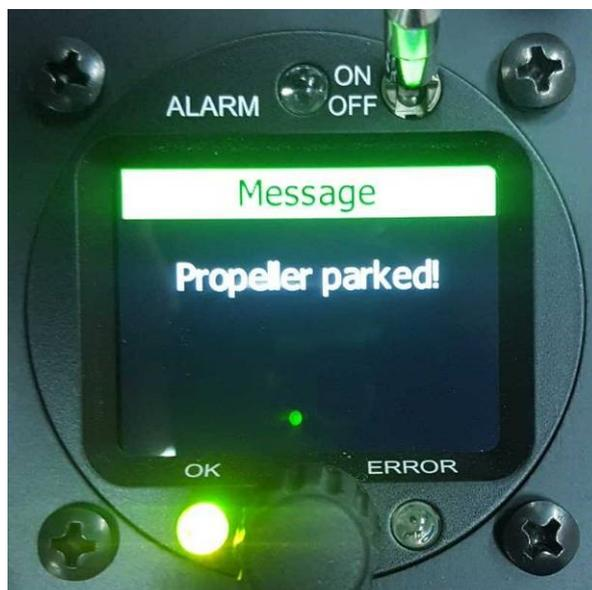
Die maximale Positionierungszeit ist standardmäßig auf 20 Sekunden eingestellt. Wird die korrekte Position in dieser Zeit nicht gefunden, erscheint für zwei Sekunden folgende Meldung:
