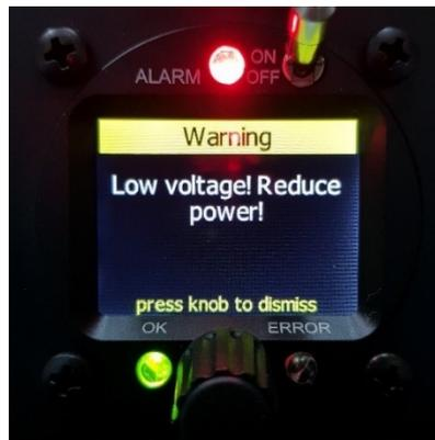
Erscheint, wenn die Gesamtspannung beider Akkupacks (unter Last) **unter 95 V** sinkt. "Reduce power!" erscheint nur, wenn mehr als 8 kW Leistung abgerufen wird.
