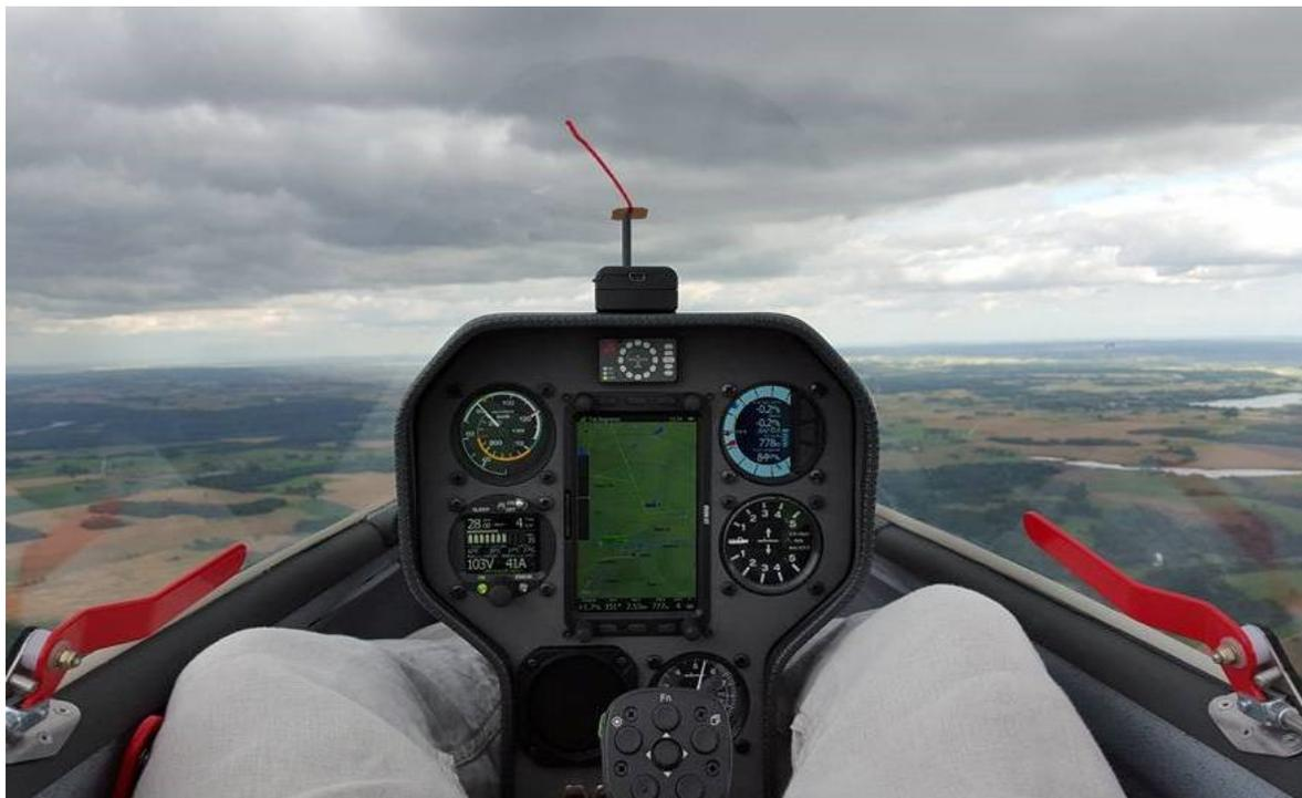
Geeignete Position der FCU im kleinen Instrumentenbrett des Silent 2 Electro
