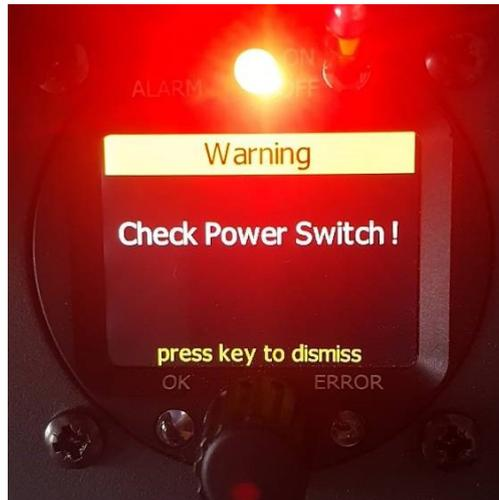
Nach der Bestätigung durch Drücken des Leistungsdrehreglers verschwindet die Warnung! Nachdem der Hauptschalter eingeschaltet ist, geht die Leistungseinstellung auf null zurück und der Pilot kann den Motor ganz normal starten!
