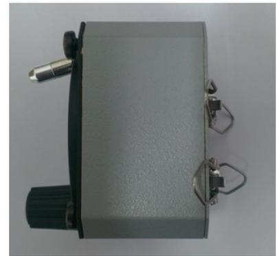
Auf der Rückseite sind zwei männliche Stecker. Die markierten weiblichen 9 und 15 poligen Stecker am Ende der Signalkabel müssen vorsichtig angeschlossen und mit den Sicherungsspannen an jedem Stecker fixiert werden.
