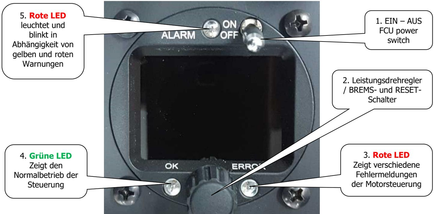
1. EIN/AUS Schalter - für die FCU Stromversorgung (verriegelte EIN/AUS Position)
