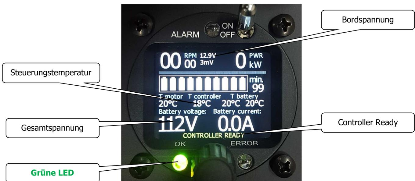
**Die grüne LED** (unten links) leuchtet dauerhaft. Dies ist eine Mitteilung der Motorsteuerung, dass alles in Ordnung ist und der Motor gestartet werden kann. Durch vorsichtiges Drehen des Leistungsdrehreglers kann der Motor gestartet werden. Der Motor startet und die Propellerblätter öffnen sich sofort durch die Zentrifugalkraft.
