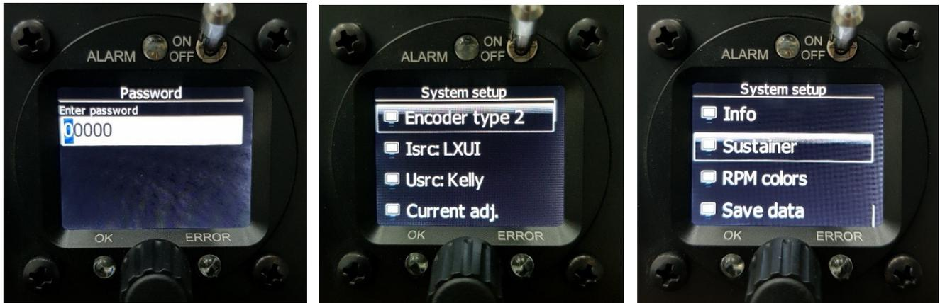
Mit dem richtigen Passwort erhält man Zugang zu den Systemeinstellungen der FCU. Die Untermenüs der Systemeinstellungen können durch Drehen des Leistungsdrehreglers im Uhrzeigersinn ausgewählt werden. Durch kurzes Drücken des Leistungsdrehreglers können die Untermenüs geöffnet und Einstellungen vorgenommen werden.
