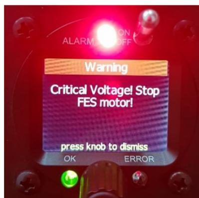
Erscheint, wenn die Gesamtspannung beider Akkupacks (unter Last) **unter 90 V** sinkt.
