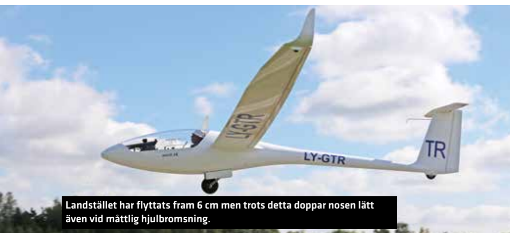
Ganska högt landställ för att propellern ska ha frigång.
