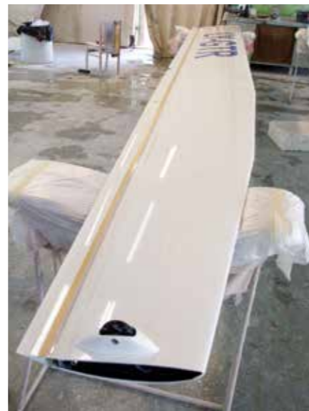
Hjul på vingspetsarna för underlätta markhantering.
