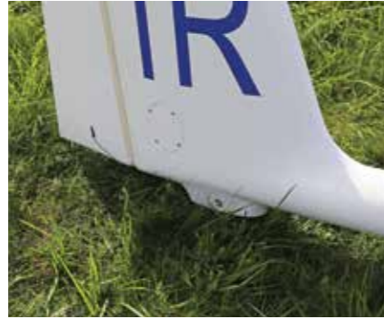
Inget styrbart sporrhjul så lite svårt att taxa med den.
