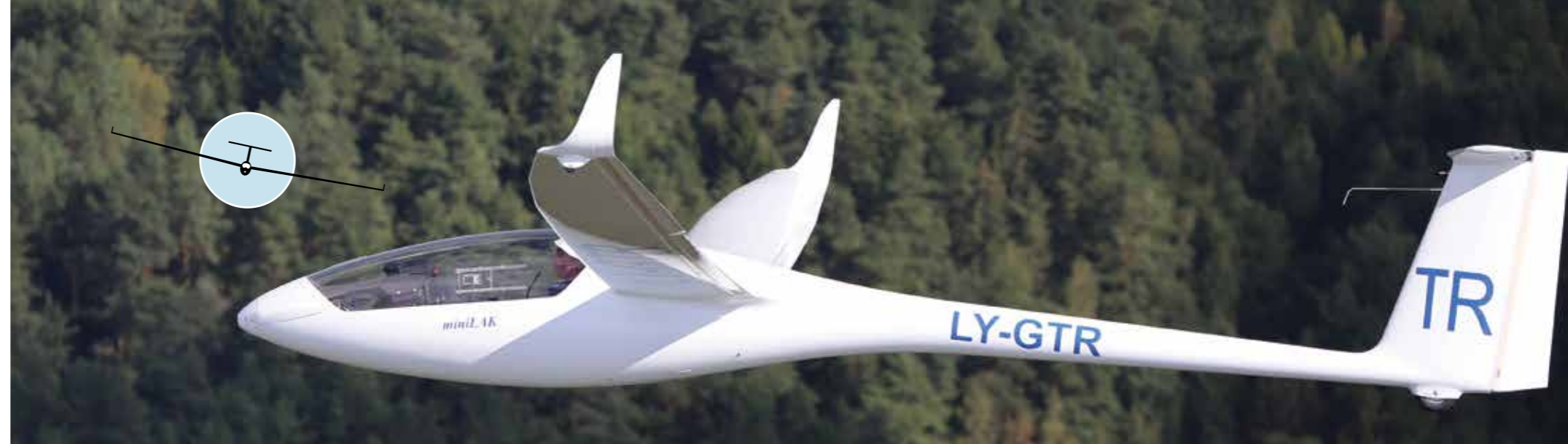
Med motorn stoppad och flöjlad är det mindre luftmotstånd än när man sticker ut sin selfie genom ventilationen. LAK 13,5 har samma kropp som storebror LAK17
