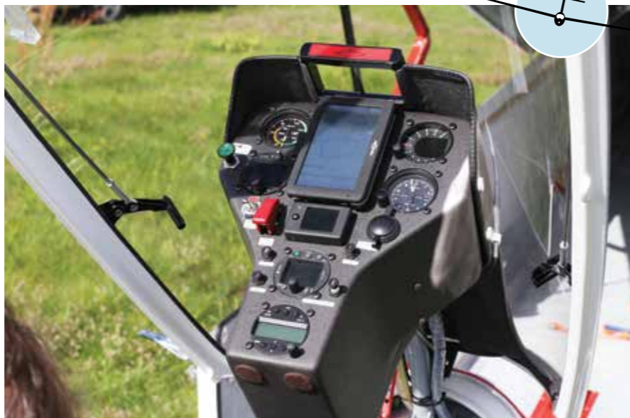
Den röda Power Switchen med FCU ovanför. Två handgrepp och tre sek från stillastående till fullgas.
