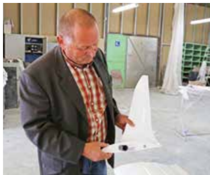
Vytautas Maciulis fra Lak visar Winglet. Den sitter fast med en liten fjäderbelastad kula. Inga sprintar eller monteringsverktyg behövs.
